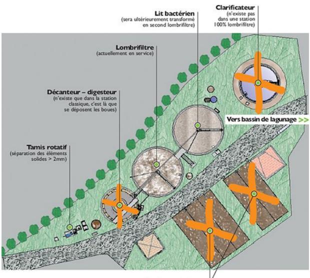
Stockage des boues (supprime dans une station 100% lombrifiltre)
